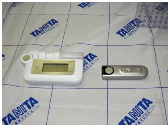
L unità principale misura 68x118x22mm per 150g di peso (batteria e soluzione
