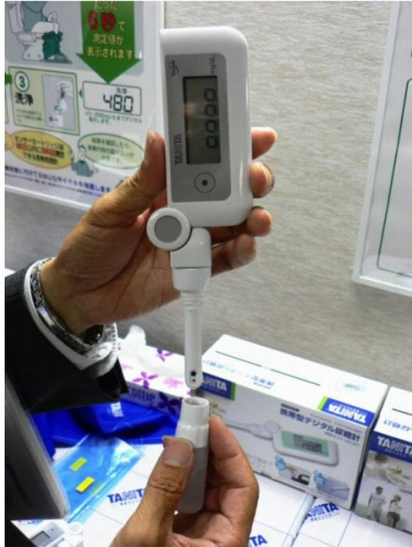
UG-201 è molto semplice da usare: basta urinare sul biosensore basato su un elettrodo a enzima.
