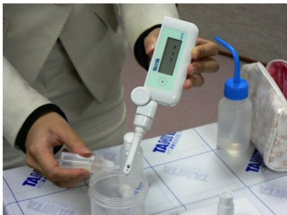
La Tanita Corp ha annunciato di aver realizzato un tester digitale portatile per misurare il livello di glucosio presente nell'urina, parametro che indirettamente da informazioni sul livello di glucosio sciolto nel sangue.
