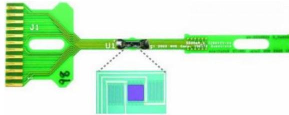
Alla Università dello Utah, gli scienziati stanno sviluppando un sensore in grado di identificare un numero di patogeni elevato partendo da un campione. La tecnica usata in questa macchina ai limiti della fantascienza è la magnetoresistenza gigante (GMR, Giant magnetoresistance).
